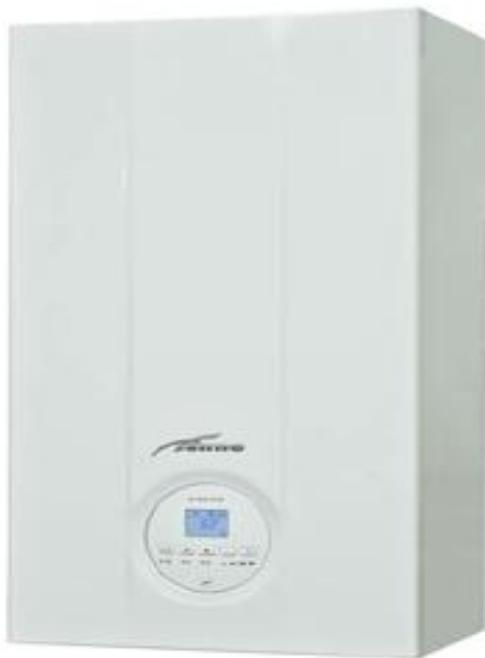
Caldera Sime modelo Brava Slim Low Nox 25BF mural de gas natural de baja emisión de nox (clase 5), estanca, de encendido por ionización y modulación electrónica. Potencia: 22.188 Kcal./h. Rendimiento del 93,4% al 100% de la potencia y del 91,9%, al 30% de la potencia. Vaso de expansión de 8 litros. presión máxima de ejercicio 3 bar. Caudal de ACS con salto térmico de 30°C: 11,5 l/min. Peso de 32 kg. Medidas: 700x400x320mm
