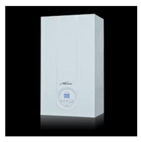
Caldera con encendido por ionización y con modulación electrónica de 1:5. Quemador de acero inoxidable. Potencia mínima 3.354 Kcal/h y potencia máxima 16.942 Kcal/h. Medidas 700 x 400 x 250 mm....
